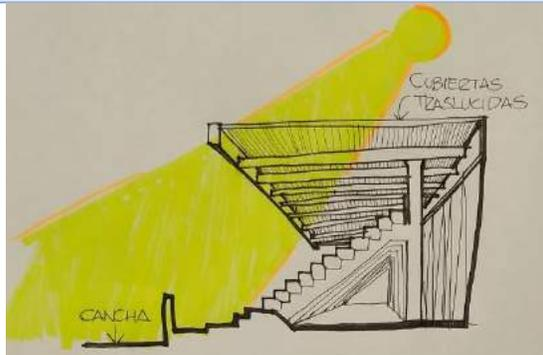
Utilizar sistemas de cubiertas traslúcidas para proteger al espectador de las condiciones climáticas, además de evitar la creación de sombras directas en el terreno de juego.
