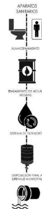
SE EMPLEARÁ UN SISTEMA DE PLANTA DE TRATAMIENTO ANAERÓBICA DE 3000 LTS. SU SISTEMA DE INYECCIÓN DE CLORO Y FILTRACIÓN PUEDE SERVIR PARA TRATAMIENTO DE LAS AGUAS NEGRAS PARA SU POSTERIOR DESFOGUE AL DRENAJE MUNICIPAL.
