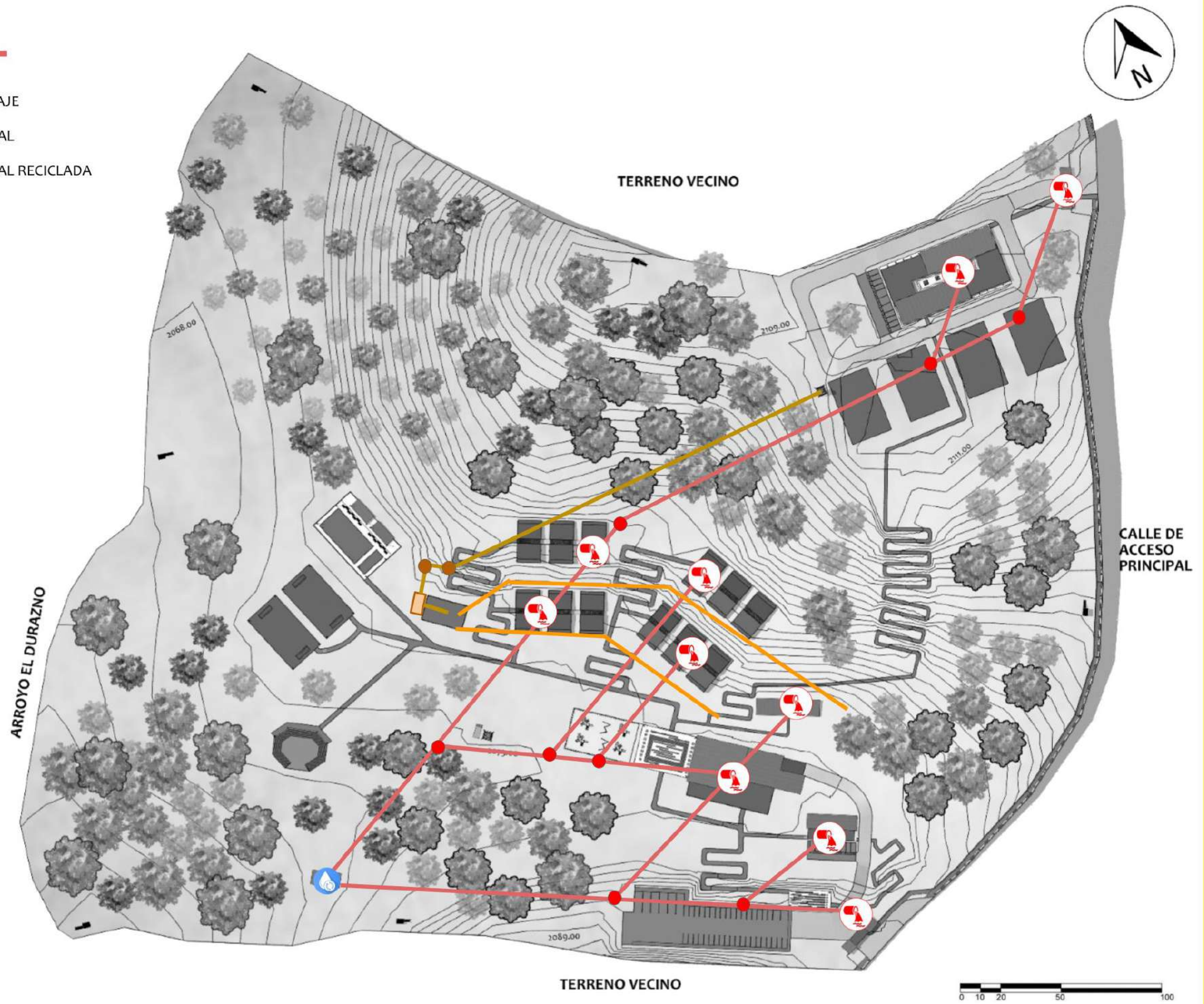
PLANTA INSTALACION DRENAJES ESCALA 1:900
