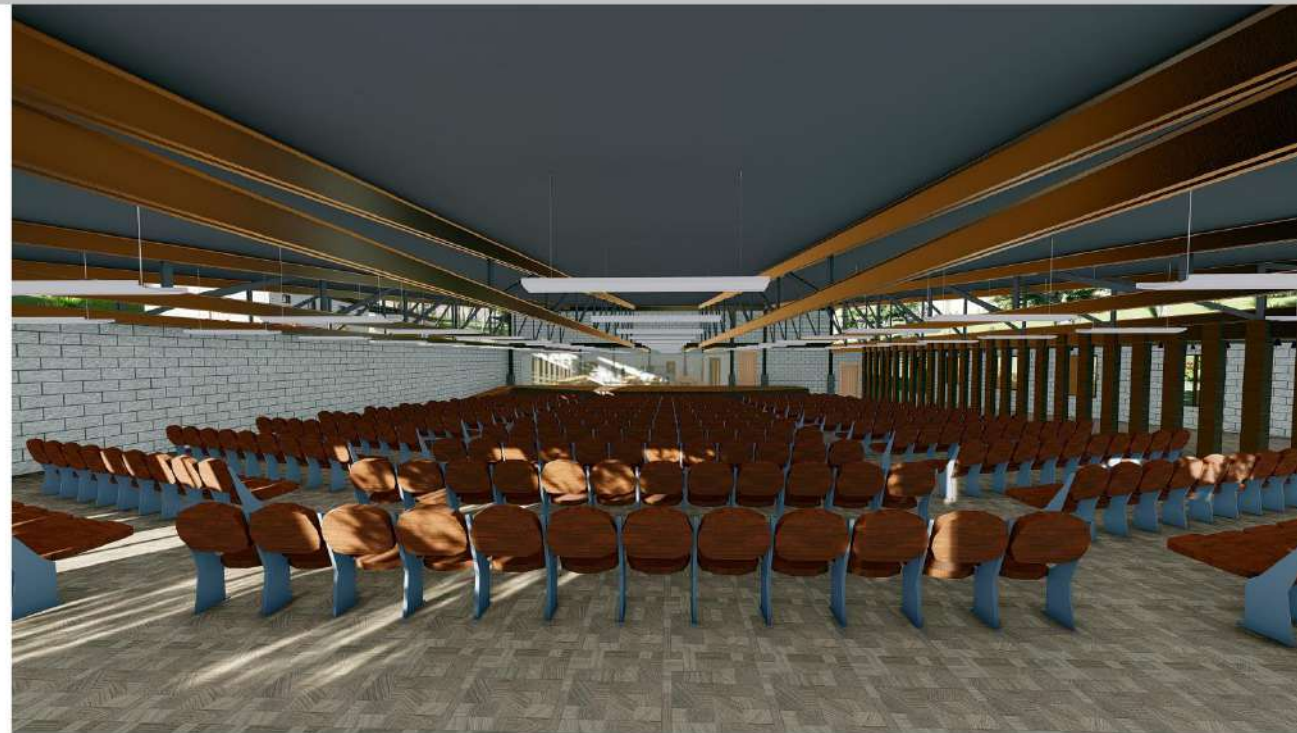
AUDITORIO EDIFICIO CENTRAL CAPACIDAD PARA 403 PERSONAS - CUENTA CON UNA PENDIENTE EN TODA EL ÁREA DE BANCAS DEL 5.37% - VENTILACIÓN EN LA PARTE ALTA DEL AUDITORIO.
