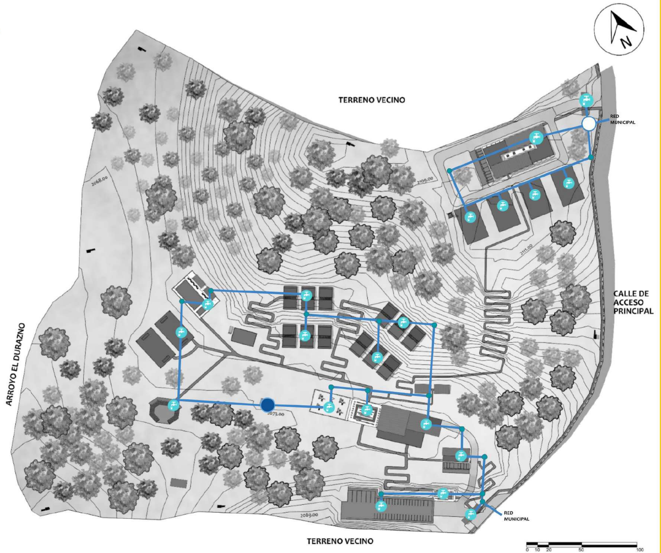
PLANTA INSTALACION AGUA POTABLE ESCALA 1:900
