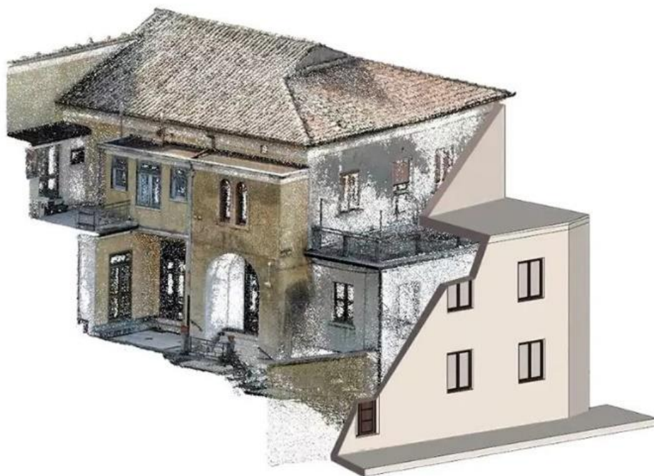
Ilustración 19. Ejemplo de un modelo de nube de puntos y BIM. FUENTE: SMARTBIM
