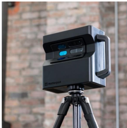
Ilustración 29. Cámara Matterport Pro-2.
