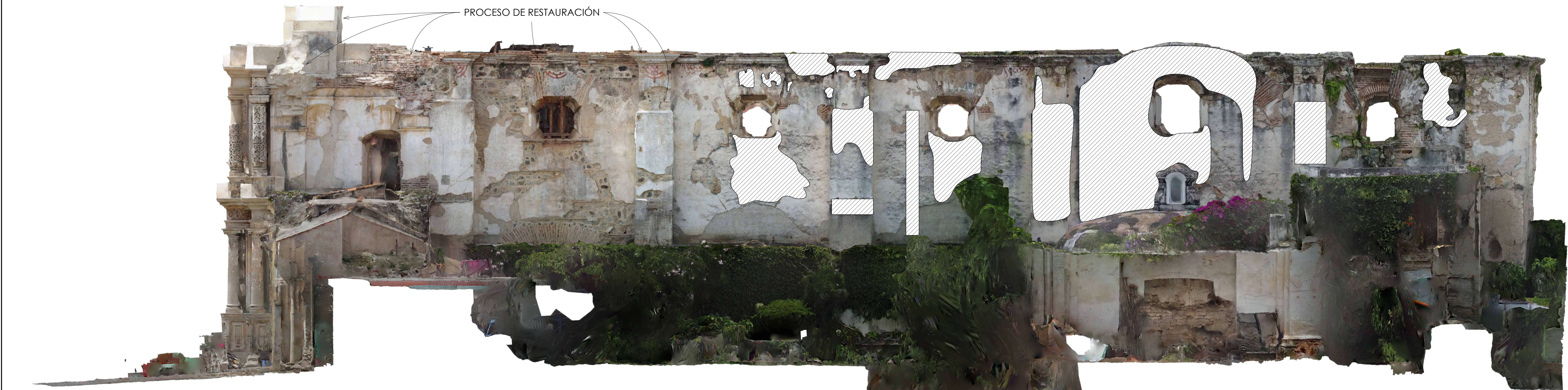
MANCHAS POR HUMEDAD 1 : 75
