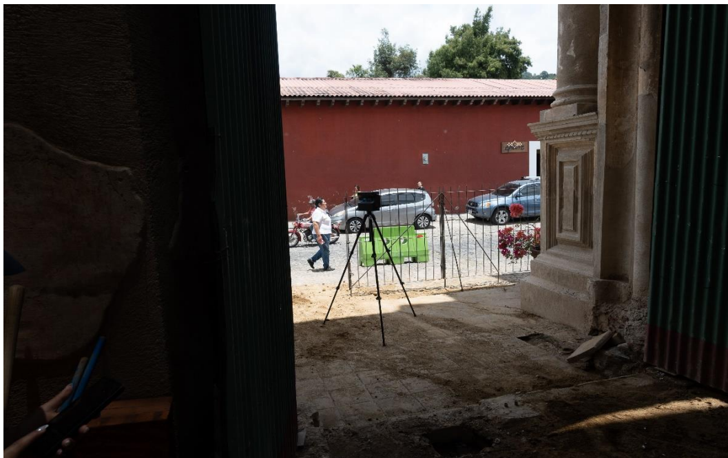
Ilustración 3. Utilización del equipo Matterport Pro 2 para el levantamiento terrestre. FUENTE: MARCELO ASTURIAS, 2023
