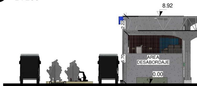
SECCION TRANSVERSAL AREA DE DESABORDAJE
