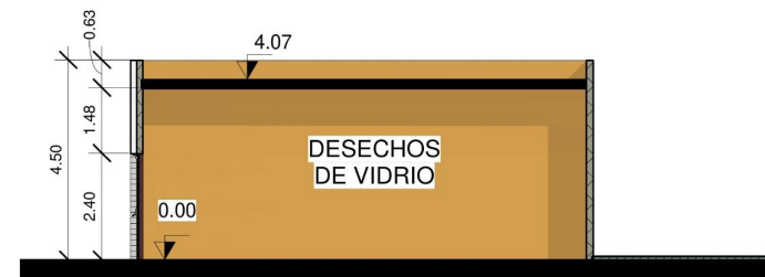
SECCION TRANSVERSAL AREA DE DESECHOS 1 : 125
