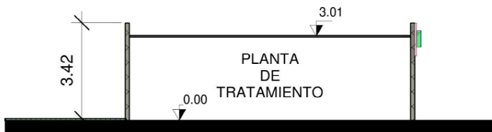
SECCION TRANSVERSAL PLANTA DE TRATAMIENTO
