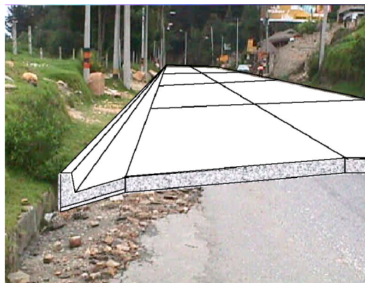
Figura 2.1 Utilización de Whitetopping para rehabilitación de carreteras.
