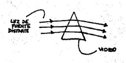
Una pieza de vidrio que tiene dos superficies planas no paralelas se llama prisma. Al pasar los rayos de luz a través del prisma emergen en dirección diferente de la que han entrado porque cada una de las superficies tienen una inclinación diferente respecto a la dirección inicial de los rayos. Este cambio de dirección se conoce como "desviación" del prisma. El grado de desviación
