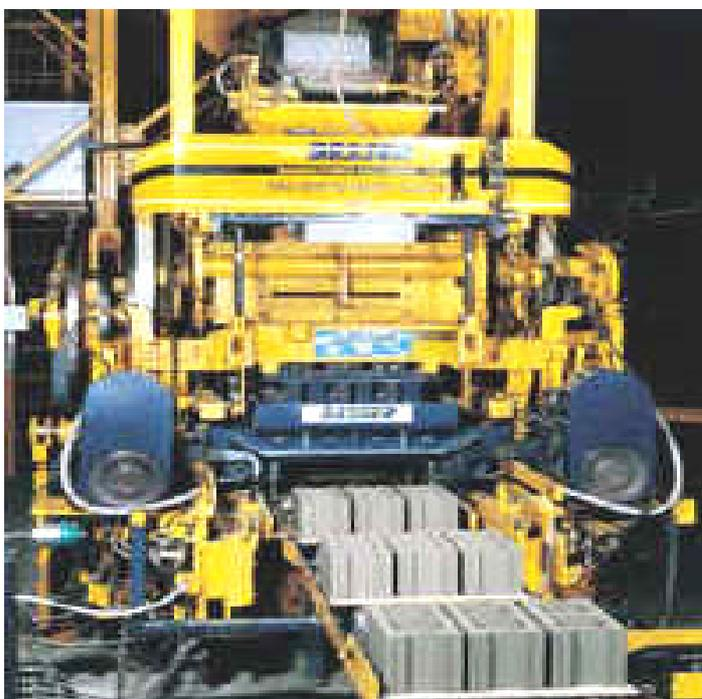
Previo a la elaboración de bloques de hormigón, deben colocarse los moldes, que determinaran el tamaño y diseño de estos, así como las bandejas o planchas de metal que contendrán los bloques recién hechos.
