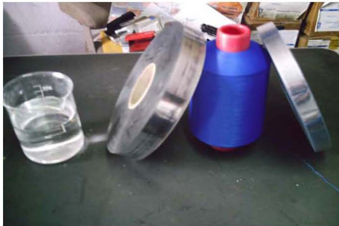
Fotografía No. 29 Acetona, acetato e hilo utilizado en la elaboración de cintas, fábrica de cintas para zapatos
