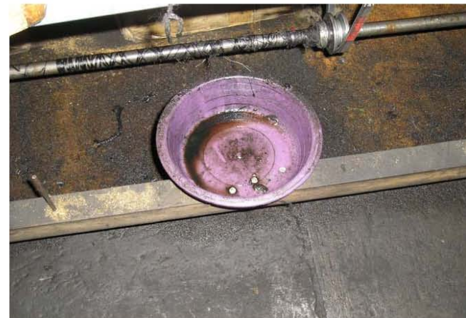
Fotografía No. 36 Recipiente con grasa, donde colocan el alma de cinta, fábrica de cintas para zapatos
