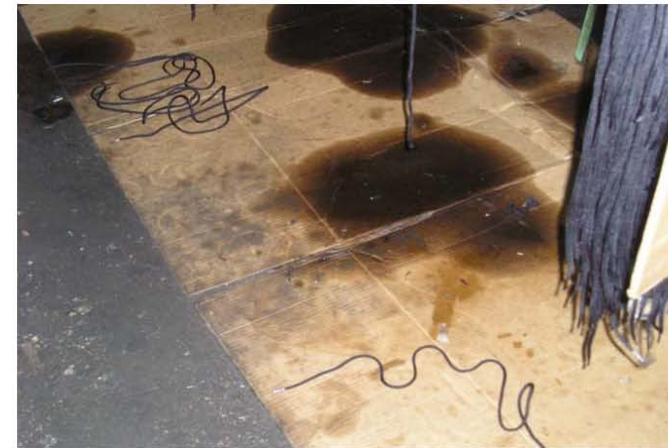
Fotografía No. 42 Cinta cortada cae al suelo con grasa, fábrica de cintas para zapatos
