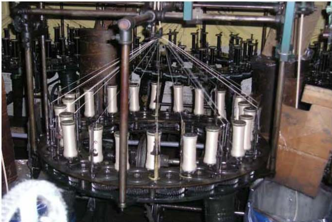
Fotografía No. 15 Máquina lista para producir cinta blanca continua, fábrica de cintas para zapatos
