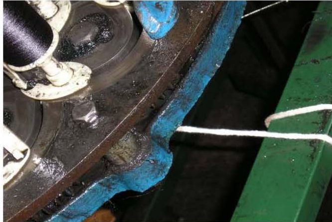
Fotografía No. 40 Alma de cinta alrededor de tubo con grasa, fábrica de cintas para zapatos
