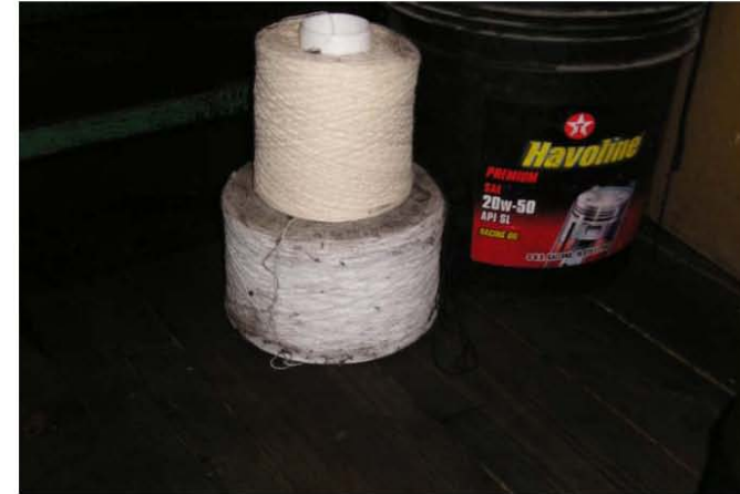
Fotografía No. 35 Hilo de algodón sucio antes de ser producto en proceso, fábrica de cintas para zapatos
