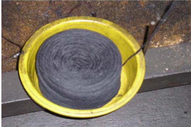
Fotografía No. 38 Alma de cinta obscura en recipiente con grasa, fábrica de cintas para zapatos
