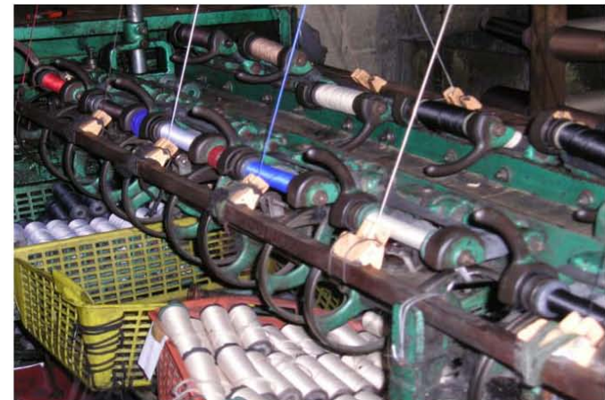
Fotografía No. 9 Máquina manual para embobinado de hilo a conos pequeños, fábrica de cintas para zapatos
