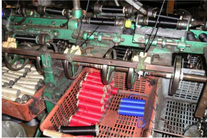
Fotografía No.10 Conos pequeños de hilo listos para etapa 2, fábrica de cintas para zapatos
