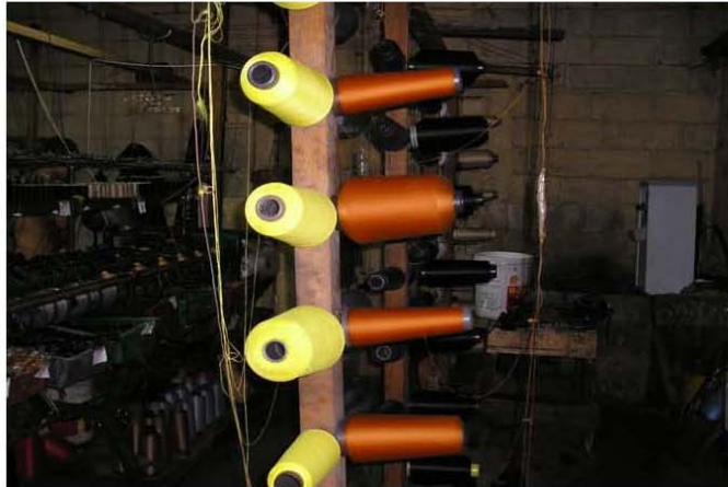
Fotografía No. 7 Conos de hilo 1 kg. de peso y 150/1 grosor, varios colores, fábrica de cintas para zapatos
