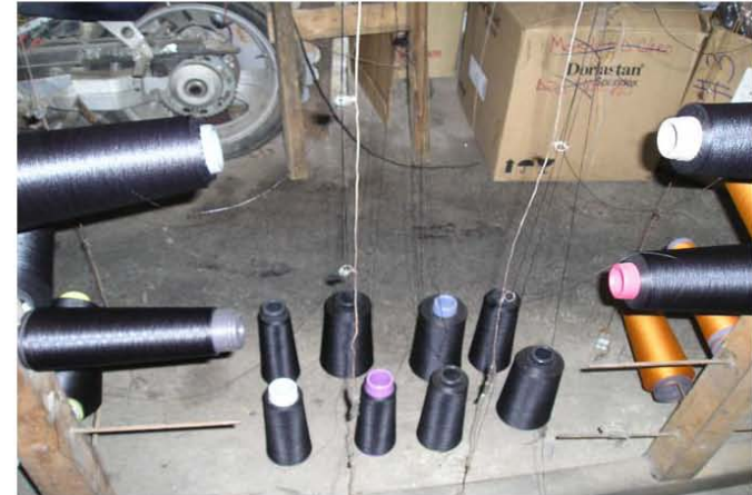
Fotografía No. 8 Conos de hilo 1 kg. de peso y 150/1 grosor, color negro, fábrica de cintas para zapatos
