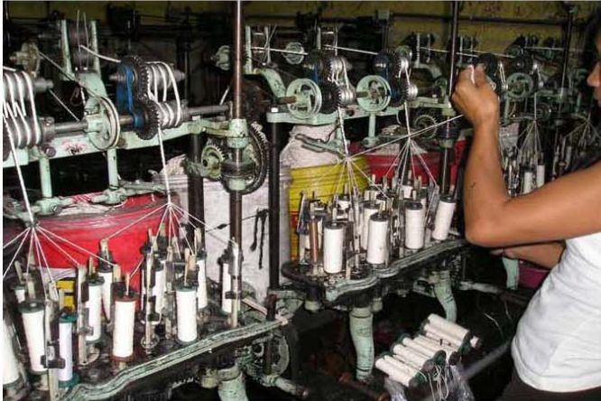
Fotografía No. 14 Finalización de colocación de conos pequeños, fábrica de cintas para zapatos
