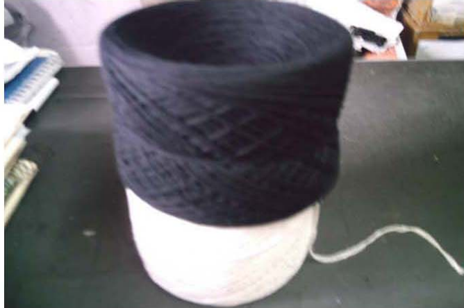
Fotografía No. 28 Hilo de algodón blanco y negro utilizado como alma de cinta, fábrica de cintas para zapatos
