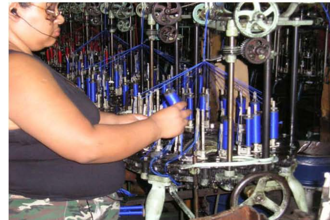
Fotografía No. 13 Proceso de colocación de conos pequeños, fábrica de cintas para zapatos
