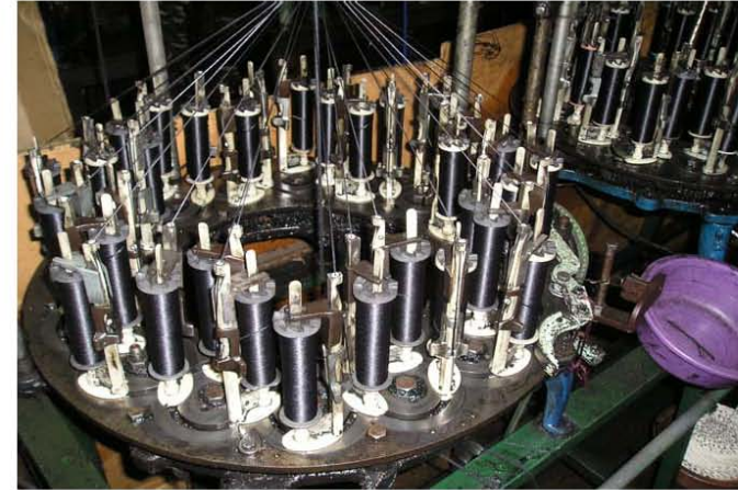
Fotografía No. 16 Máquina produciendo cinta negra continua, fábrica de cintas para zapatos
