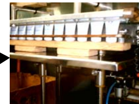
Proceso de tubo ejecutar sellado
