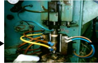
Inyección del tubo y boquilla
