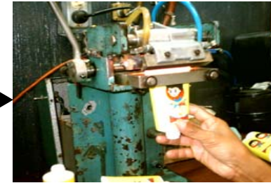
Centra e inserta el tubo para sellado. INSPECCIÓN
