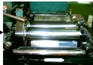
Se realiza proceso de impresión del tubo
