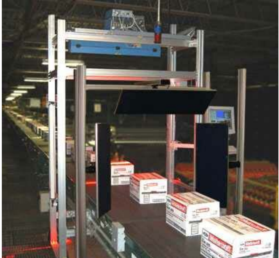
Fotografía 3 Lectura de información por lector a través de antenas
