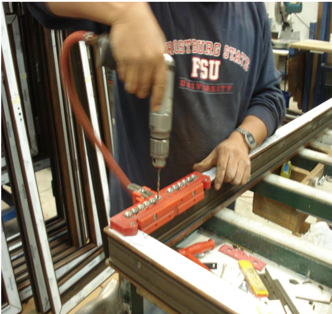
Fotografía No. 8 Montaje del herraje
