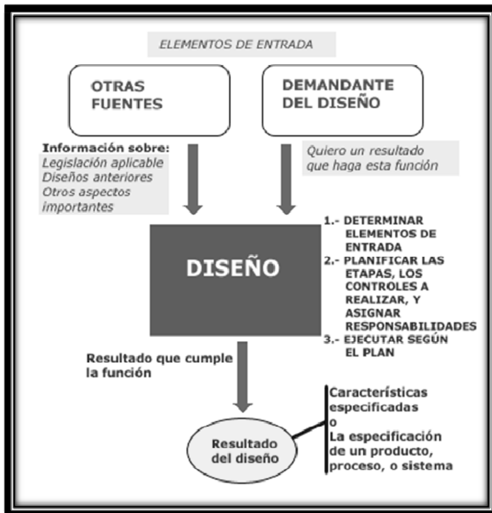
Figura 4 Esquema del proceso de diseño
