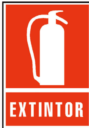
Figura 13 Señalización para ubicación de extintores
