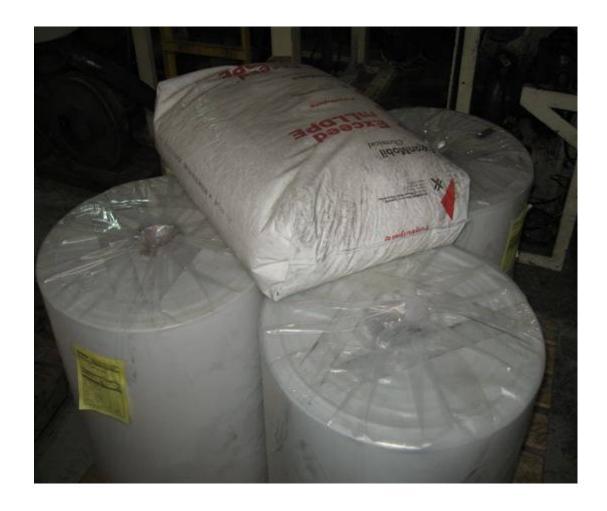
En la fotografía, se puede apreciar las bobinas que son el producto terminado en Extrusión y sobre ellas un saco de materia prima.
