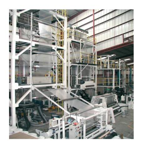
En esta fotografía, se puede apreciar a una máquina extrusora procesando las resinas.
