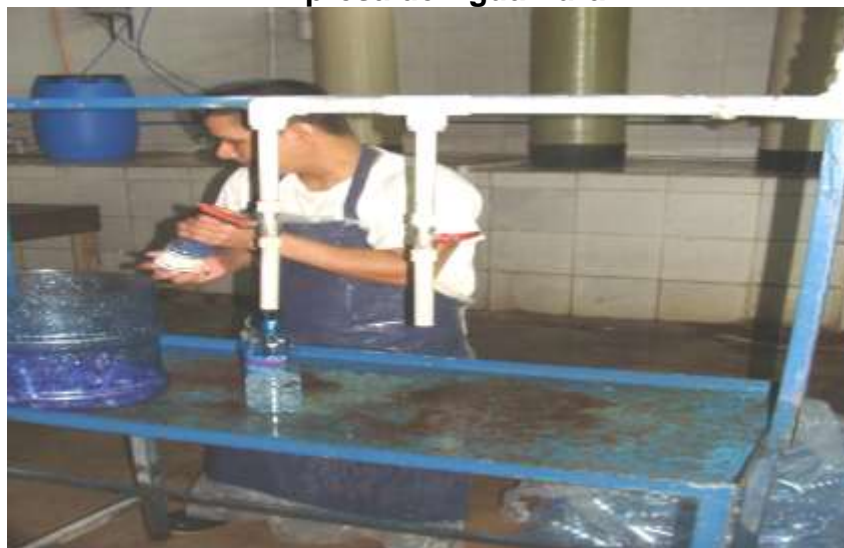
Fotografía No. 39 Máquina llenadora de envase de 0.6 litros Empresa de Agua Pura
