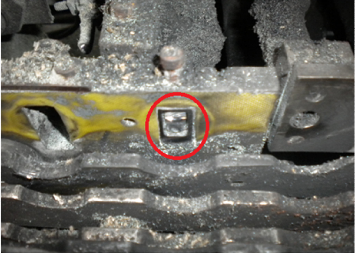
Fotografía 7 Sensor de roldana de fondo con residuos de mezcla y de papel
