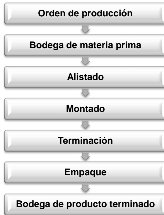
Figura 8 Proceso de fabricación de calzado
