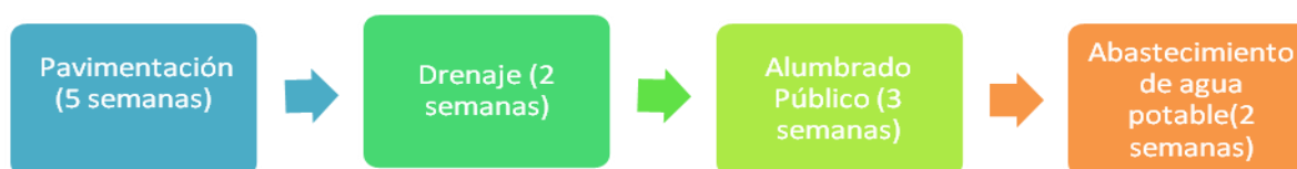
Ilustración No. 16 Diagrama de actividades principales de Urbanización, Zaragoza, Proyecto Habitacional, Chimaltenango, 2013
