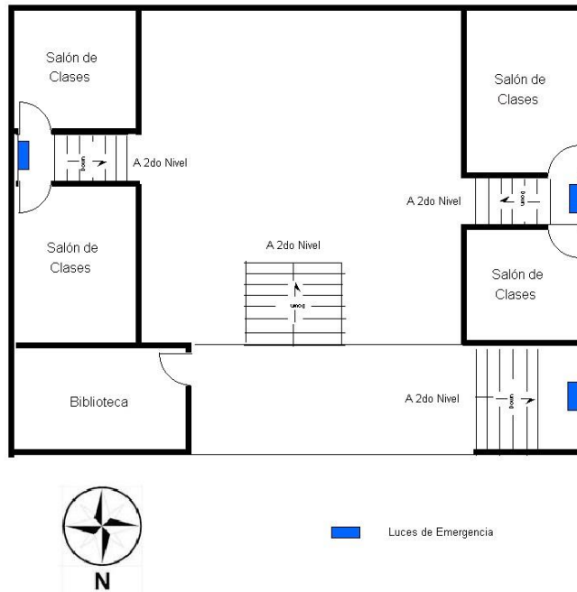
Imagen 45 Ubicación de lámparas de emergencia Tercer nivel parte de atrás
