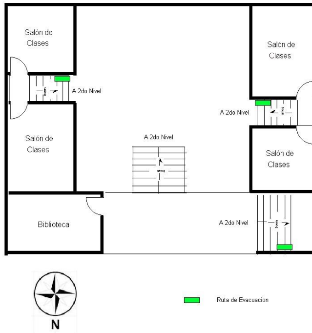
Imagen 33 Ubicación señales de rutas de evacuación Tercer Nivel parte de atrás
