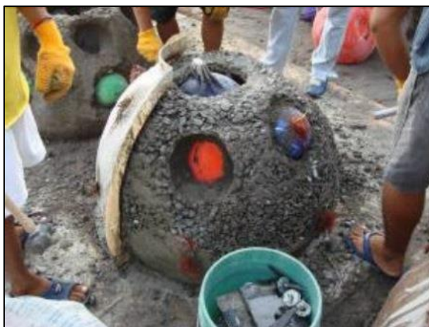
Figura 9. Desarmado del molde. Fuente: UNIPESCA, 2008.
