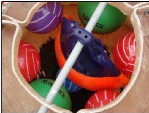
Figura 7. Armado de los moldes para arrecifes artificiales tipo reef ball . Fuente: UNIPESCA, 2008.
