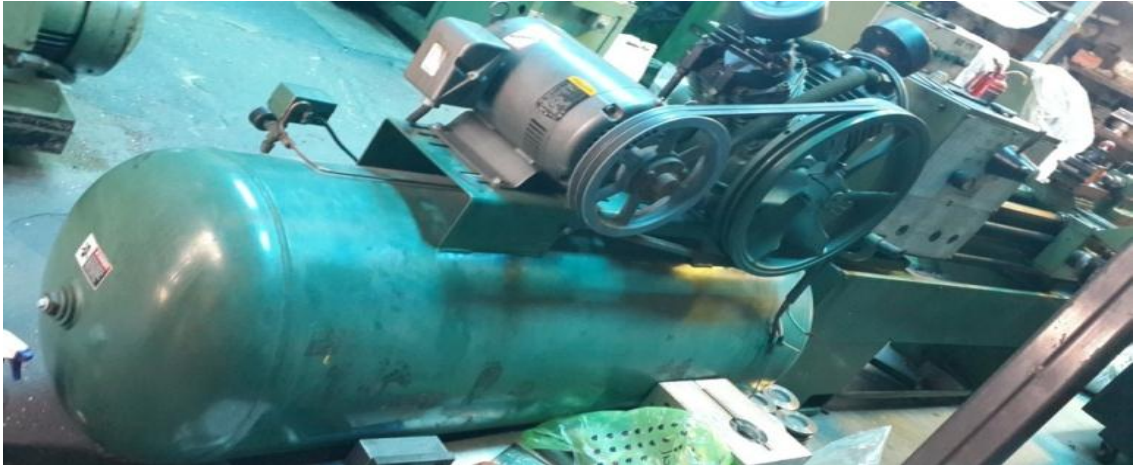
Figura 19 Compresor complemento maquinaria.
