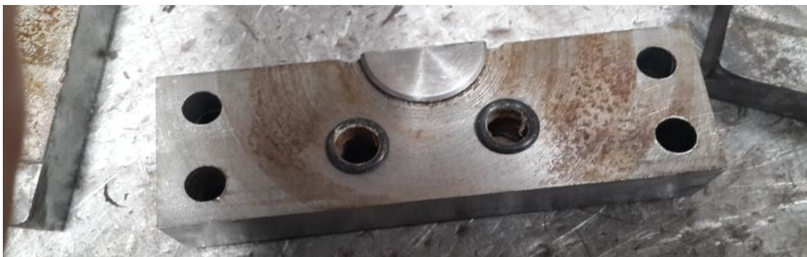
Figura 12 Canales de enfriamiento de un molde de soplado
