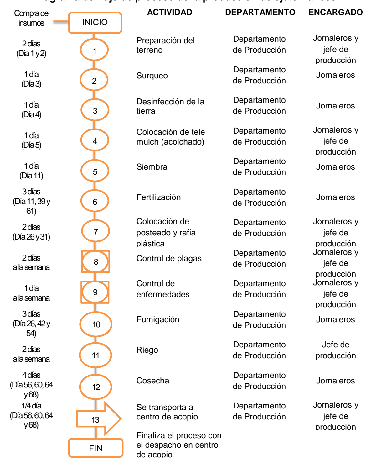
Figura 33 Diagrama de flujo de proceso de la producción de ejote francés 23
