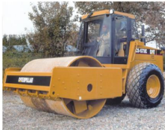
Rodo Compactador Compactar material.
