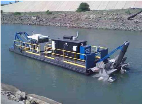
Una draga de sedimentación, es una embarcación de distintas dimensiones, diseñada para dragar materiales del fondo del río o del lecho marino, el material es aspirado
