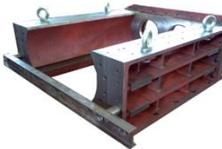
(3) Las protecciones laterales adicionales están diseñados para reducir el riesgo de daños o contaminación de la cámara de trituración cuando se procesa el material contaminado.
