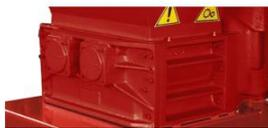
(2) El diseño de la carcasa curva de las cuchillas de contador garantiza la limpieza y evita cualquier tensión a la pared lateral.
