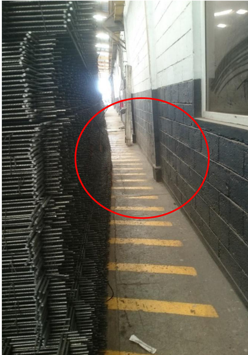
Imagen 24 Obstrucción de caminamientos
