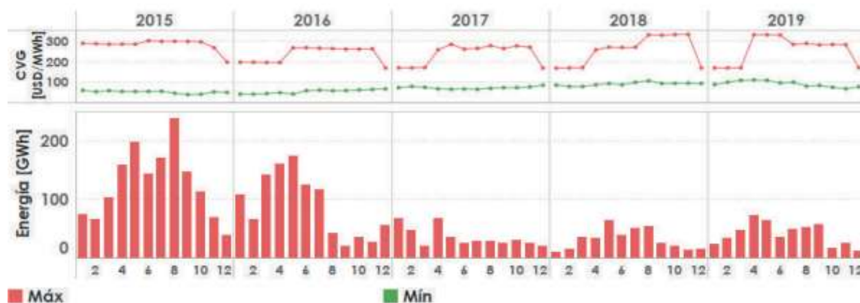
Figura 3 Evolución de los costos variables de generación y de la energía producida de las centrales de Bunker. Copyright 2019-2020. Comisión Nacional de Energía Eléctrica.
