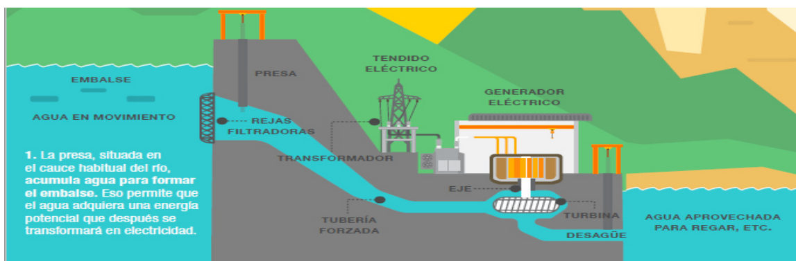
Figura 2.1: Proceso de planta hidroeléctrica
