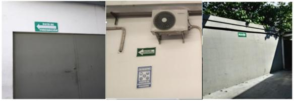
Como se observa en las imágenes anteriores, la empresa cuenta con rutas de evacuación con sus debidas señalizaciones, es importante mencionar que la altura de algunas no es la adecuada sobrepasando los 2.5 metros de altura, lo correcto según las Guías de Señalización, de CONRED, debe ser a una altura de 1 y 1.2 m como rango recomendado.
