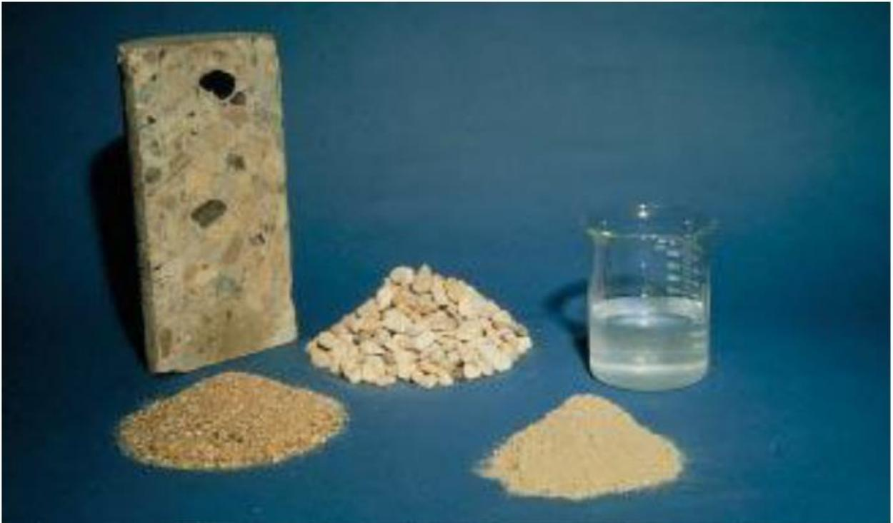
*Nota.* La figura muestra los componentes del concreto, los cuales son cemento, agregado fino, agregado grueso y agua. Fuente: Kosmatka, (1994).
