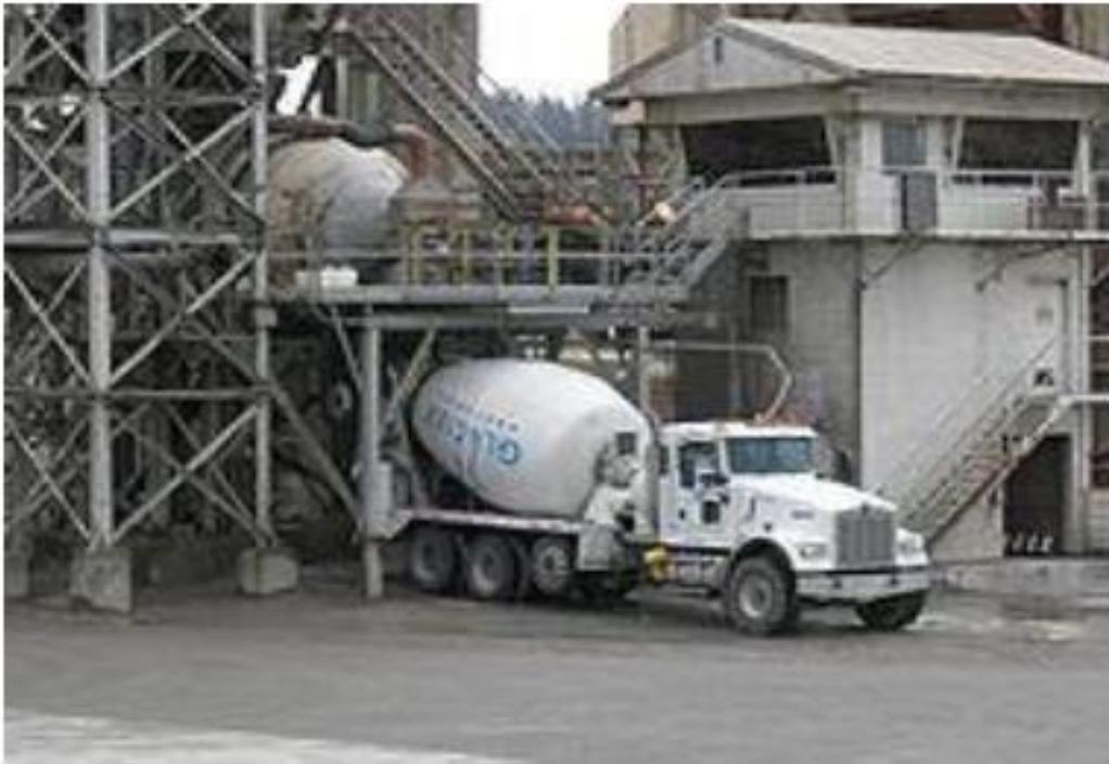
*Nota:* En la figura se puede observar al camión mezclador cargando un pedido de concreto en la planta dosificadora, el camión ingresa de retroceso y se posiciona de tal manera que el tanque del cumbo se conecta con el dosificador para recibir la carga según la fórmula establecida del tipo de concreto que corresponde a ese pedido. Fuente: Departamento de Operaciones de la empresa del sector construcción, (2021)
