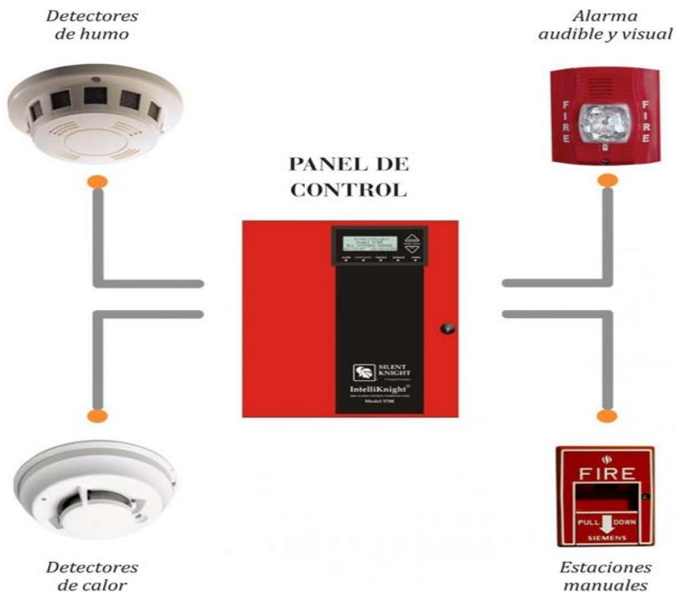
Sistema de detección y alarma contra incendios
