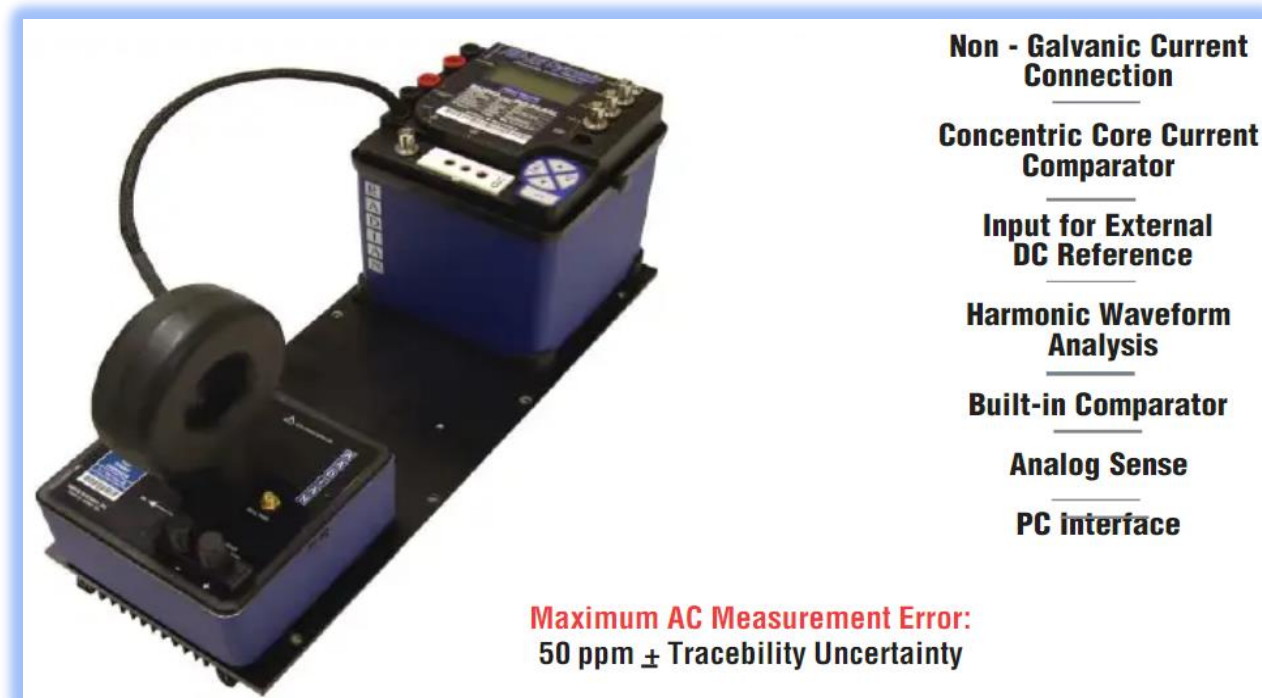
Figura 7 patrón viajero Radian RD22 del laboratorio de metrología de EEGSA
