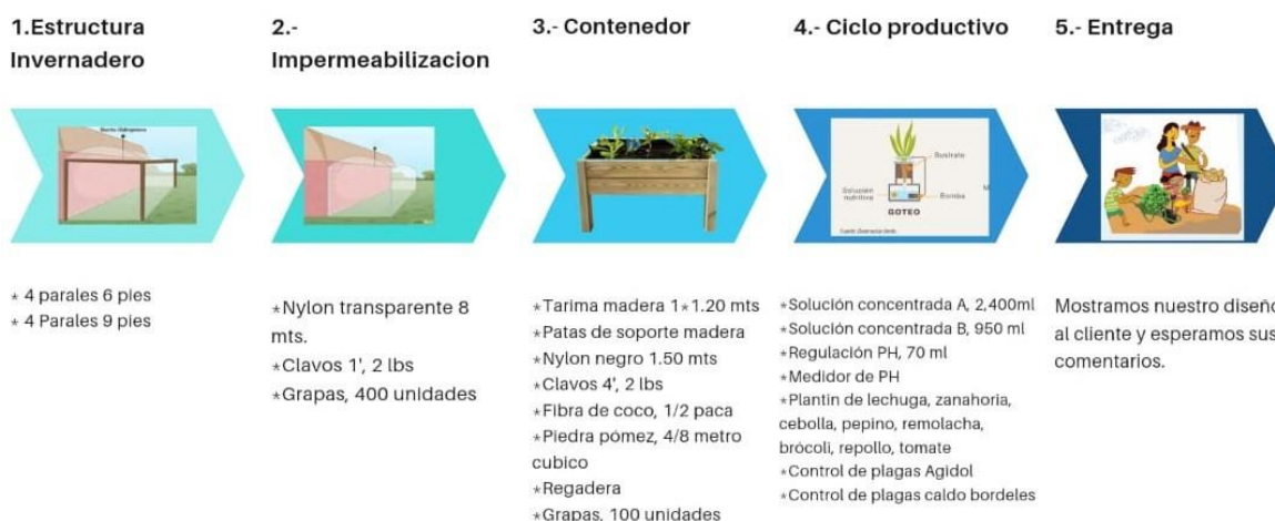
Figura 26 Diagrama de materiales para huerto hidropónico.
