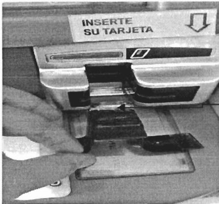
Dispositivo, colocado en la rejilla del cajero automático el cual obtiene la información de una tarjeta de debito.
