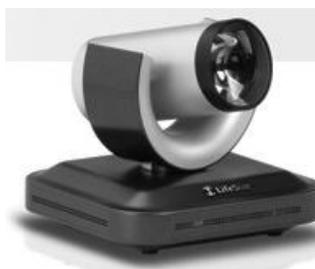
**3) Cámara robótica:** Es la cámara incluida en cualquier equipo, ésta es manejada a través de la tableta de control.
