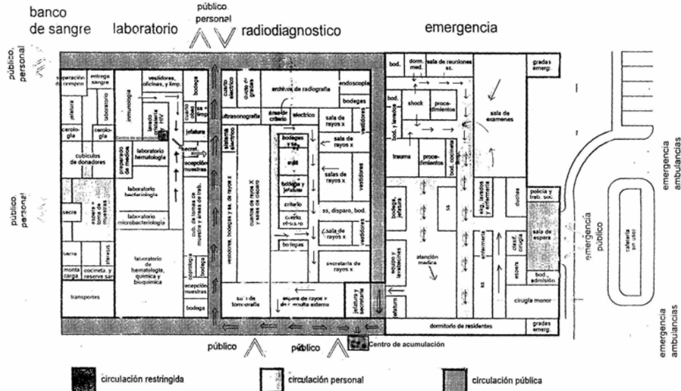
diagrama de funcionamiento actual de emergencia de adultos y sus servicios de apoyo, del edificio de servicios médicos (1er. nivel) del hospital general san juan de dios
