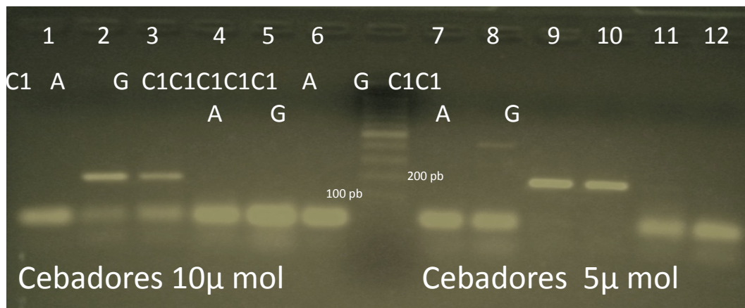
Figura 5.5RCP Polimorfismo FNT \alpha -308. Prueba de Cebadores a una concentración de 10 \mu mol. Se utilizó un control interno (C1) del gen de Hormona de Crecimiento Humano, producto de RCP de 429 pares de bases, positivo pozo 8. Las siglas A y G corresponden alélelo A (A), alelo G (G). No hubo amplificación de producto de RCP en los posos 1,4, 5, 6,7, 11 y 12.
