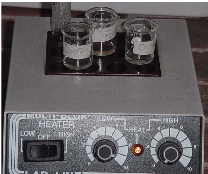
Baño seco de temperatura controlada con bloques calefactores
