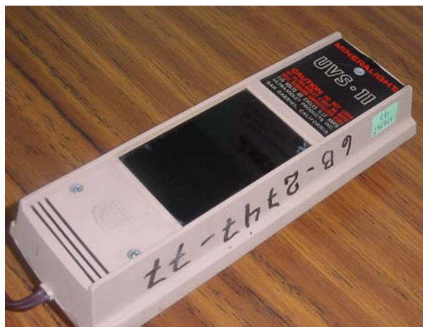
Lámpara UV de longitud de onda corta (254 nm)
