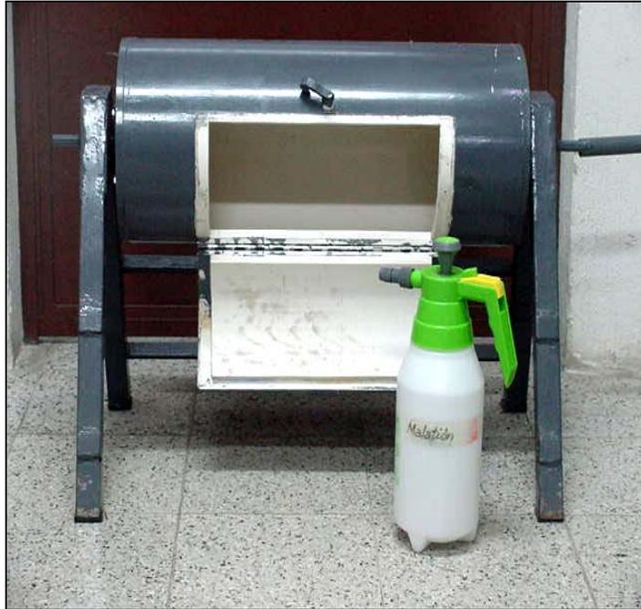
Ilustración 2. Tambor de rotación y bomba de aspersión utilizados para impregnar olote con malatión.
