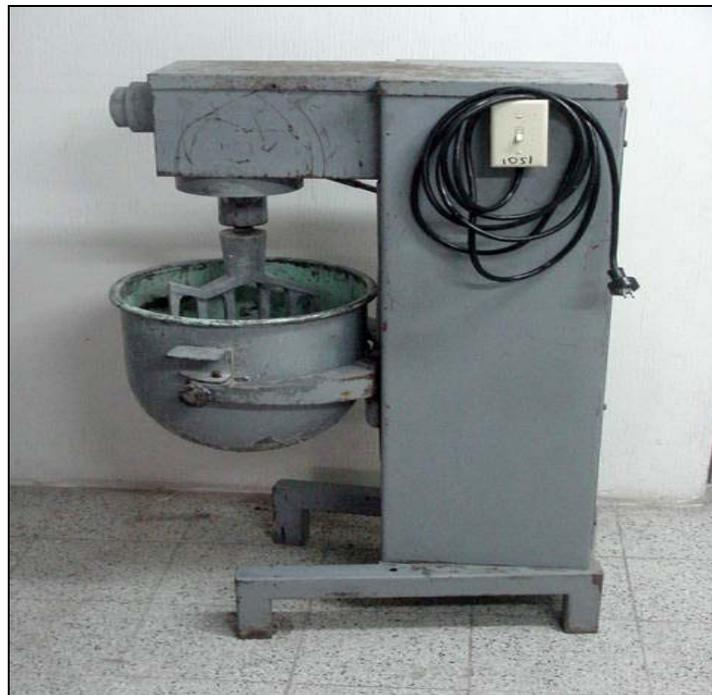
Ilustración 3. Mezcladora utilizada para preparar la dieta.
