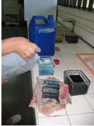
Llenado de las pilas con alcohol para eliminar el exceso del colorante.
