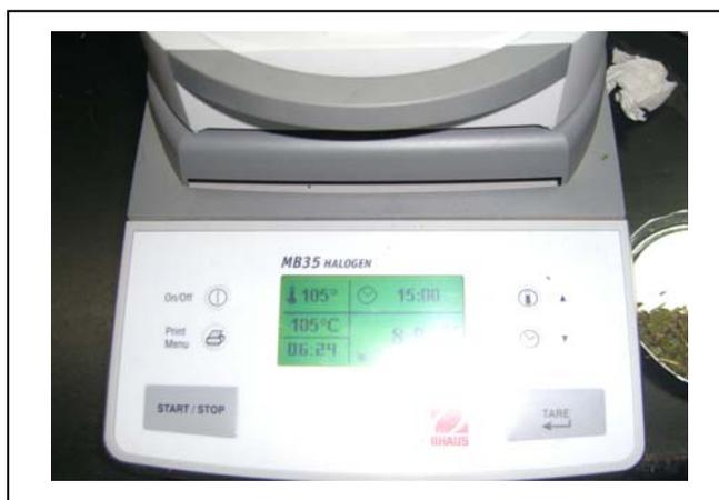
Figura 3. Balanza de humedad marca Halogen
