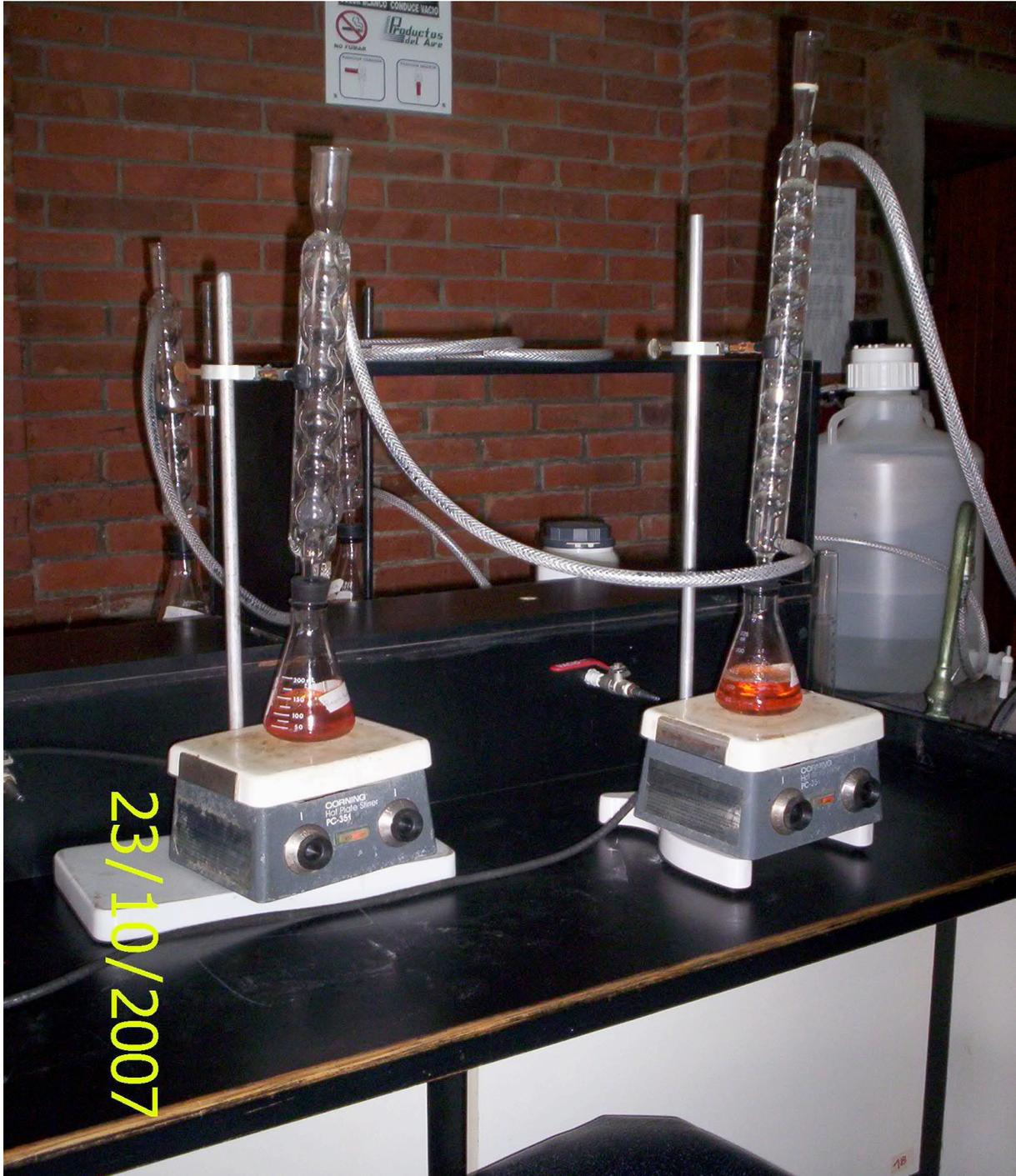
**Fotografía No.1:** Vista del equipo utilizado para el reflujo que requiere el método oficial AOCS Ca 14-56, para la determinación del contenido de glicerina total.
