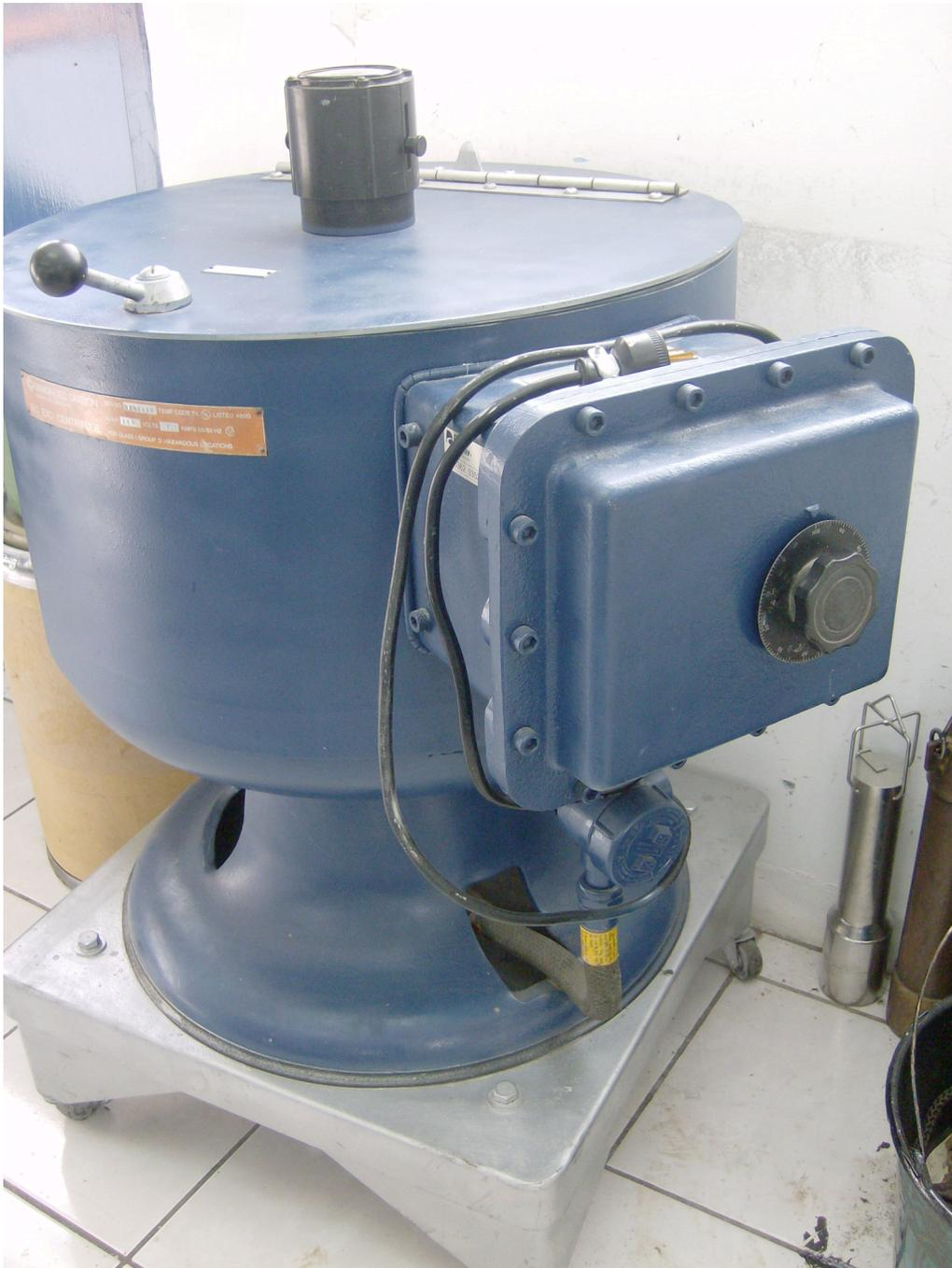
**Fotografía No.3:** Vista de la centrífuga utilizada para la determinación de contenido de humedad y sedimentos en las muestras de biodiesel tratadas y sin tratar.
