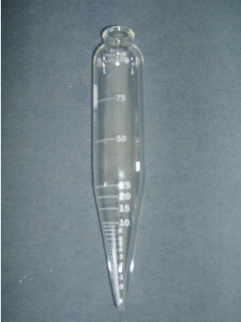
**Fotografía No. 5:** Tubo utilizado para realizar la determinación de humedad y sedimentos (ASTM D 2709) por centrifugación, se puede observar la graduación que posee el mismo para poder realizar la lectura directa.
