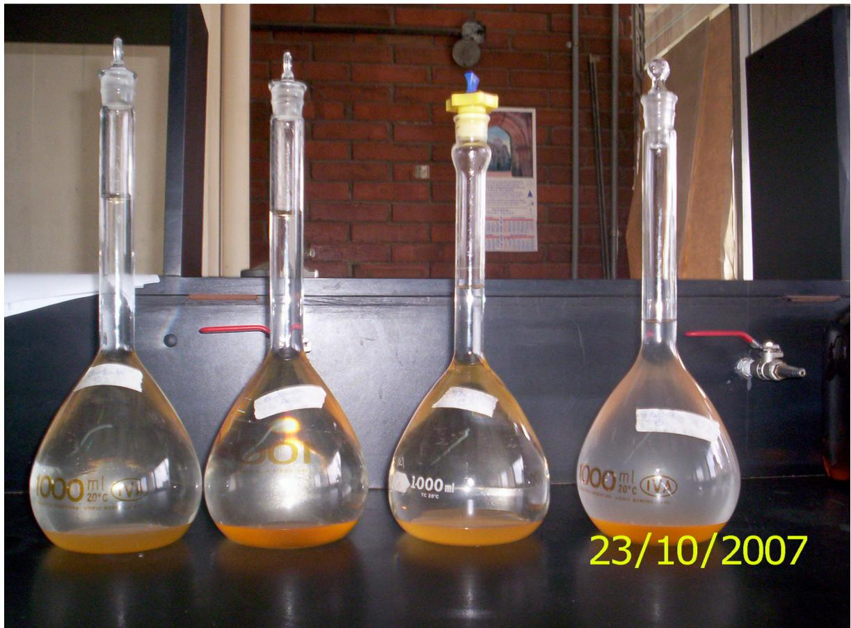
**Fotografía No. 2:** Luego del reflujó de 30 minutos, las muestras deben ser trasladadas hacia balones aforados que contienen ácido acético y cloroformo, la solución acuosa es la que se utiliza para la determinación del contenido de glicerina total por medio del método yodométrico AOCS Ca 14-56.
