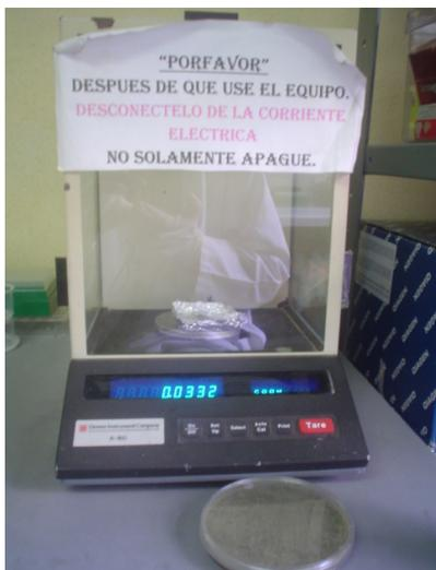
Balanza electrónica empleada para pesar las esporas
