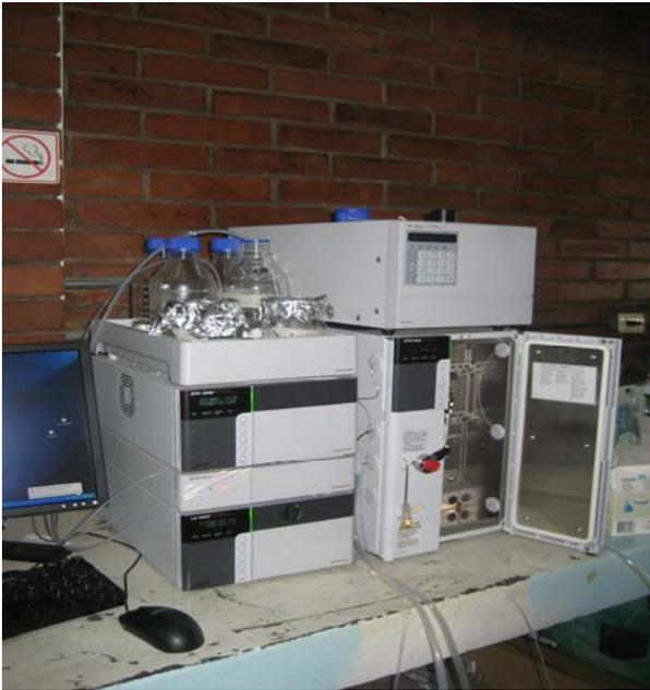
Foto 1. Cromatógrafo Líquido de Alta Resolución.
