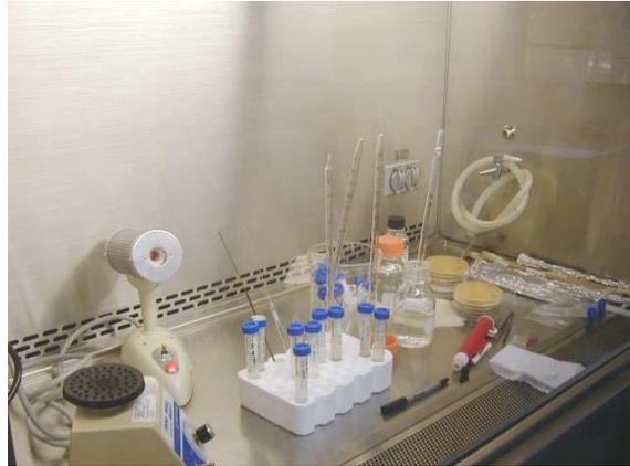
**Fig. 2. Campana de flujo laminar con equipo utilizado para la preparación de inóculos a diferentes concentraciones.**
