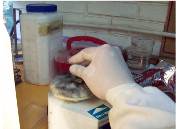
Fotografía 11. Agitación para completar la transesterificación
