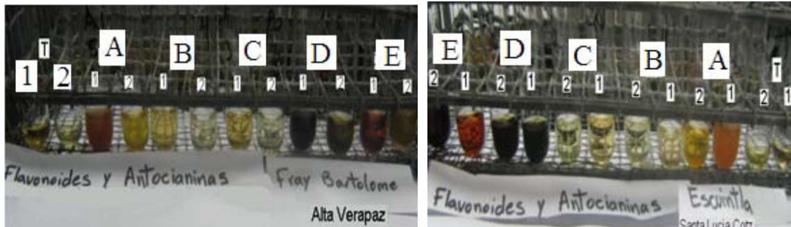
Figura 16. Pruebas preliminares 1=rizoma, 2= fronda, T=testigo, A = NaOH, B = MgHCl, C=HCl, D=FeCl 3 10% E=H 2 SO 4
