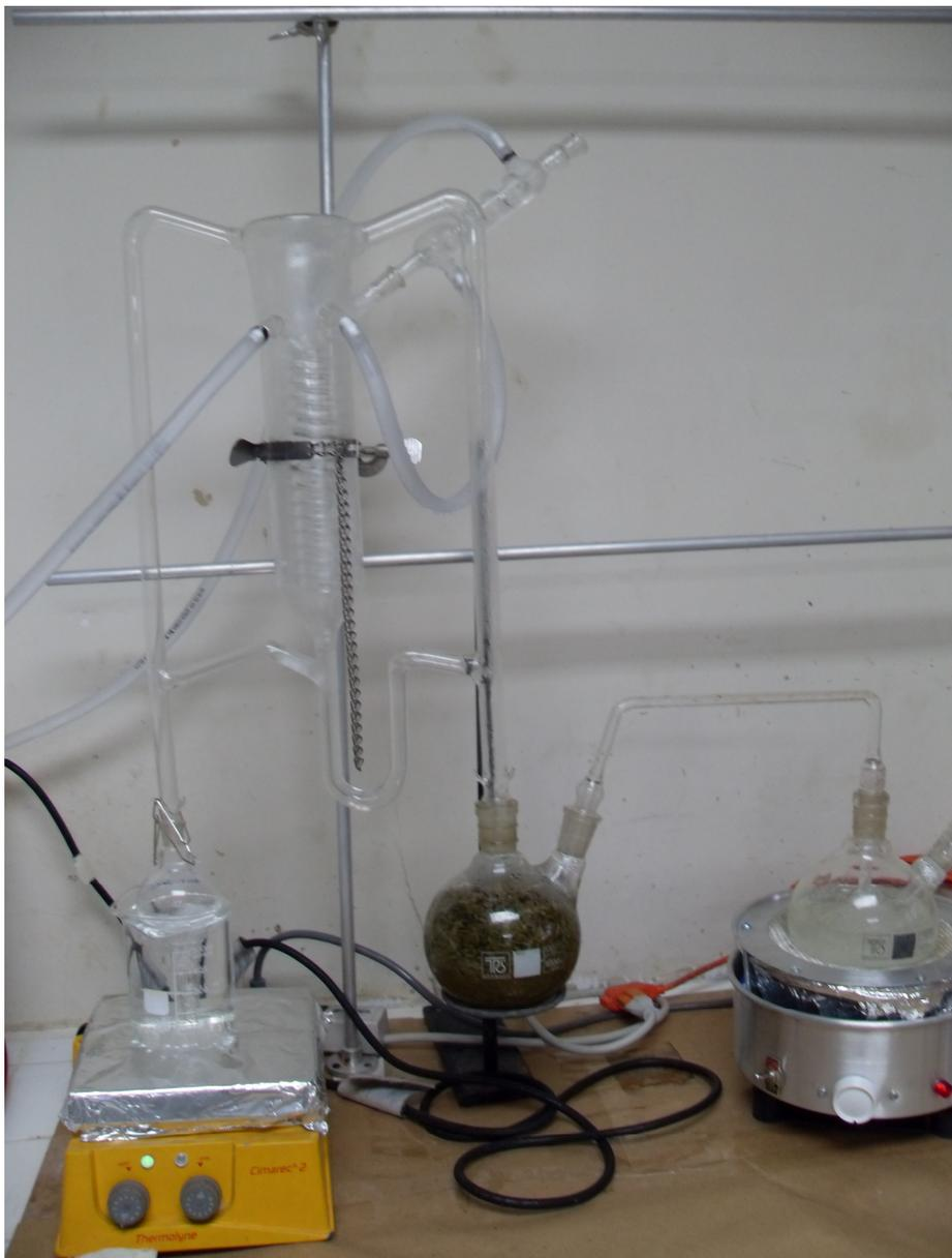
A la derecha de la imagen se observa el balón con agua en ebullición (A). El vapor es transportado al balón con el material vegetal (B) y arrastra el aceite esencial hacia el aparato Likens-Nickerson (C) donde se condensa por el flujo de un refrigerante. El n-pentano proviene del balón en baño maría (D) y también se condensa en el aparato Likens-Nickerson, donde recoge el aceite esencial. Fotografía: Christian Farfán.
