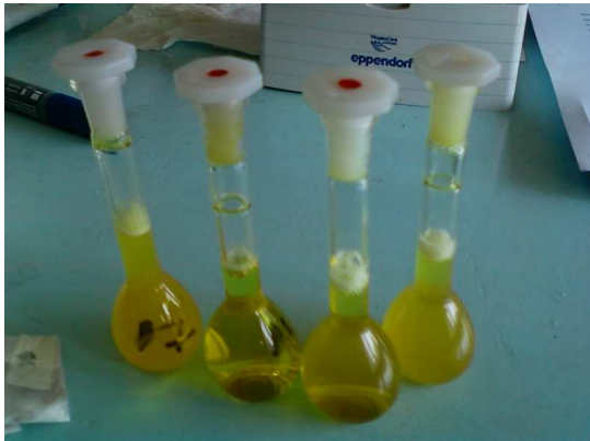
Fig.13.3.8 Reconstitución de muestras con HCl diluído.
