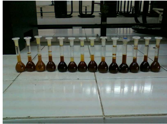
Fig. 13.3.7 Reconstitución de muestras con agua destilada.
