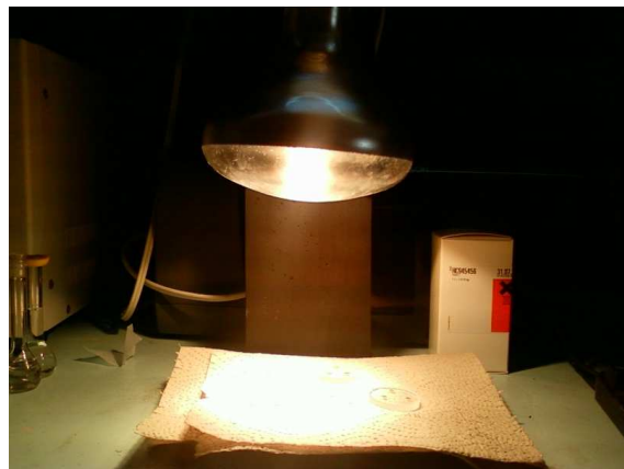
Fig.13.3.10 Secado de muestra para análisis por Fluorescencia de Rayos X
