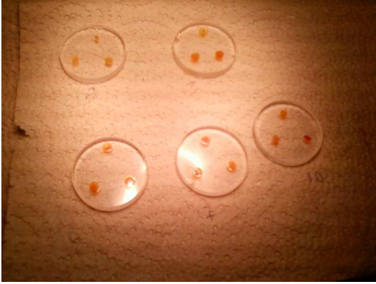
Fig.13.3.11 Muestras preparadas para análisis por Fluorescencia de Rayos X
