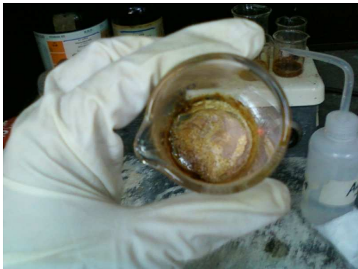
Fig. 13.3.6 Evaporación de ácidos presentes en las muestras previamente digeridas.
