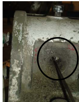
FIGURA 44. Entrada y salida de alambre por la caja de polvo lubricante
