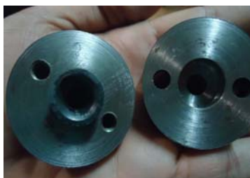
FIGURA 42. Defectos presentados en el dado de tungsteno
