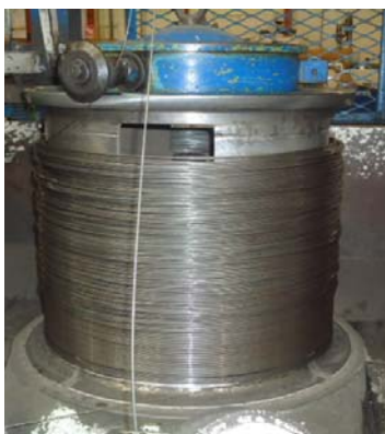
FIGURA 28. Nivel adecuado de alambre en la bobina
