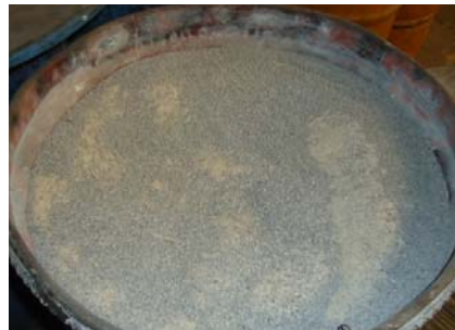
FIGURA 4. Lubricante en seco utilizado para el proceso de trefilación
