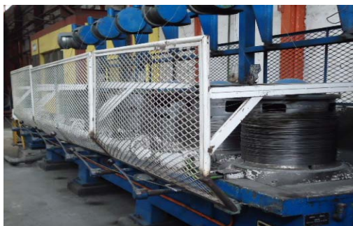
FIGURA 5. Trefiladora mecánica utilizada durante el proceso de trefilación
