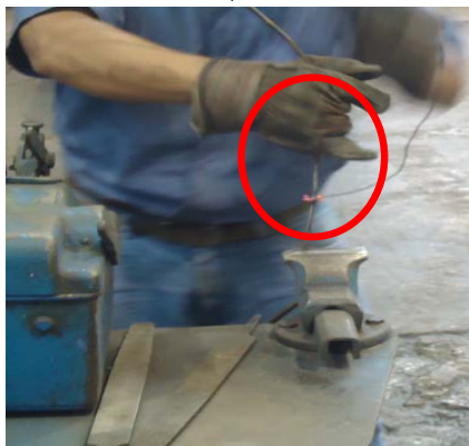
Colocar extremos soldados en prensa.
