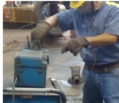
Colocar 2do. Extremo en soldadora.
