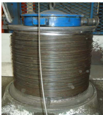
FIGURA 28. Nivel adecuado de alambre en la bobina
