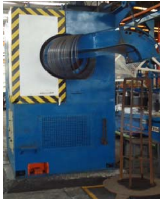
FIGURA 48. Canasta vacía y lista para llenarse de alambre nuevamente
