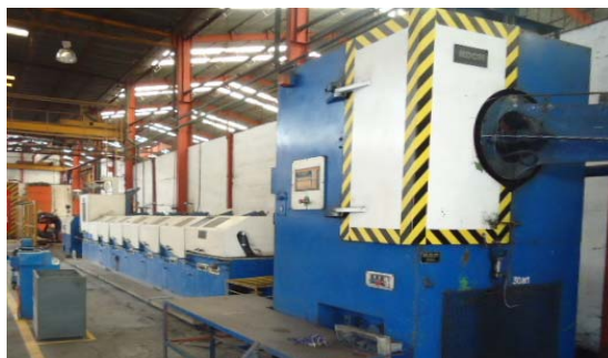
FIGURA 6. Trefiladora computarizada utilizada durante el proceso de trefilación
