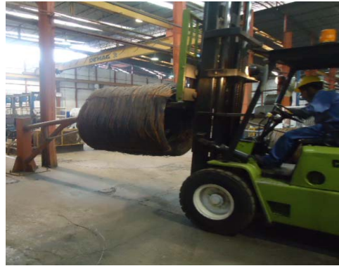
Colocado parcial de alambón.
