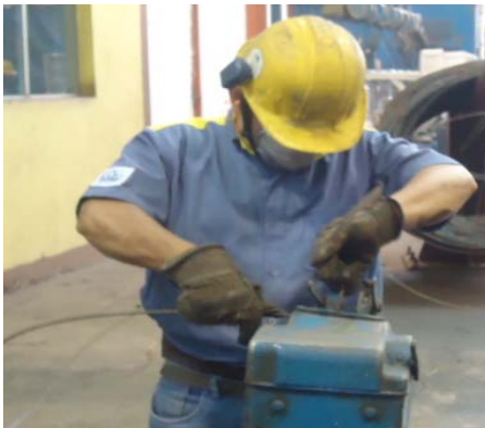
Colocar 1er. Extremo en soldadora.
