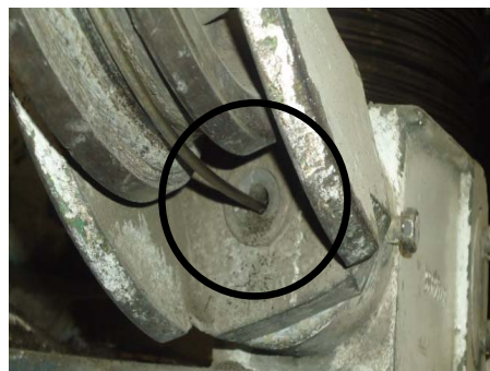
FIGURA 44. Entrada y salida de alambre por la caja de polvo lubricante
