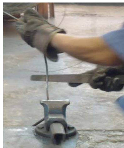
Limar y eliminar rebaba de soldadura.
